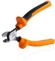
Outils à couper pour conducteurs jusqu'à 8 mm, 12 mm, 14 mm et 22 mm de diamètre extérieur. La géométrie de coupe spéciale assure une coupe nette et sans écrasement des conducteurs en cuivre et aluminium avec un effort physique minimum. En outre, les outils de coupe (KT 8 à KT 22) sont munis d'une protection isolante testée VDE et GS jusqu'à 1 000 V, conformément aux normes EN/CEI 60900.
